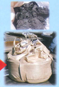
上段:脱水後の汚泥 下段:脱水後自立状態
